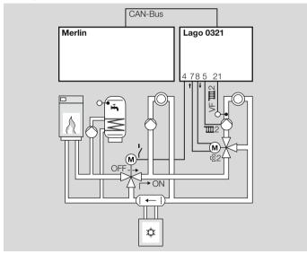
Le régulateur central Merlin 5064 active le "mode rafraîchissement" via le bus de communication CAN et pilote le générateur, la
