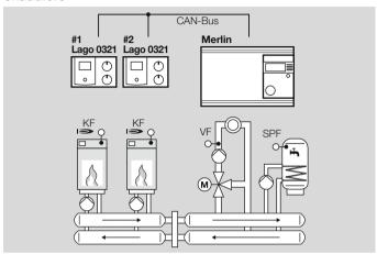
Cette application se configurera automatiquement dès que vous aurez raccordé une sonde chaudière (KF/KFS) et réglé le paramètre 38 = 1-8 (adresse module chaudière).
