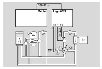
La vanne se trouvant dans le circuit fonctionne en tant que vanne bipasse. La vanne s'ouvre (ON). La pompe est enclenchée.
