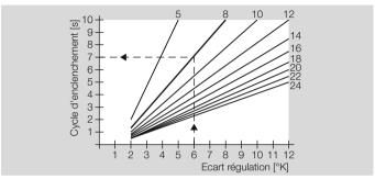
Avec un écart de température de 6 K, la vanne est pilotée durant 7 s et reste à l'arrêt pendant 3 s.
