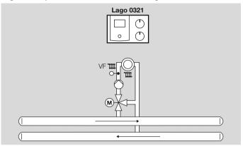
Si une seule sonde départ est raccordée (VF/VFAS), cette application se configurera automatiquement.
