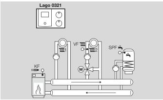
Raccorder sonde générateur (KF/KFS), sonde départ (VF/VFAS) et sonde E.C.S. (SPF/SPFS),
