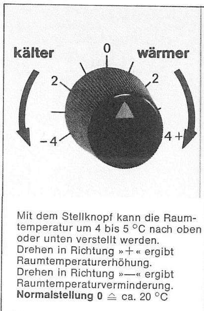
Bild 18 Temperatureinstellung an der Fernbedienung FB 2
