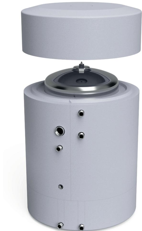
4. Nachdem Sie das Kopfteil abgenommen haben, können Sie die drei Seitenteile der Isolierung, die ringförmig um den Speicherbehälter angeordnet sind, abnehmen. Entfernen Sie auch die beiden kleinen Isolierstücke im Sockel. Achten Sie darauf, dass Sie die Anschlussstutzen nicht verbiegen.
